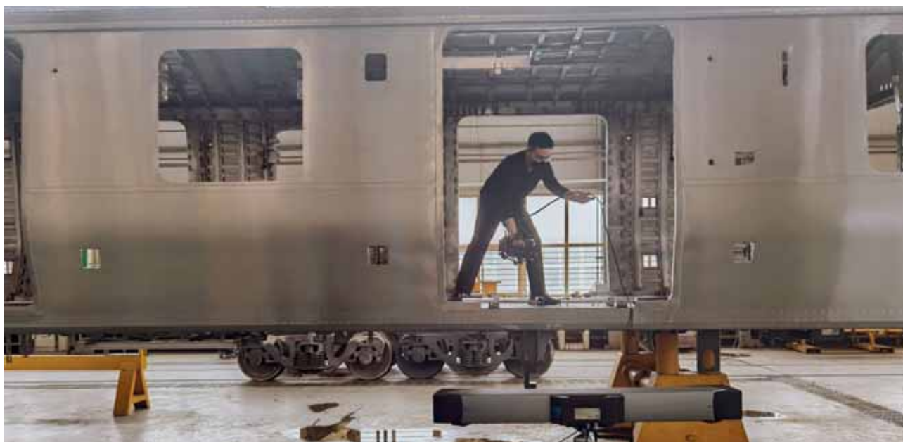
Контроль сварки железного кузова высокоскоростного транспорта
